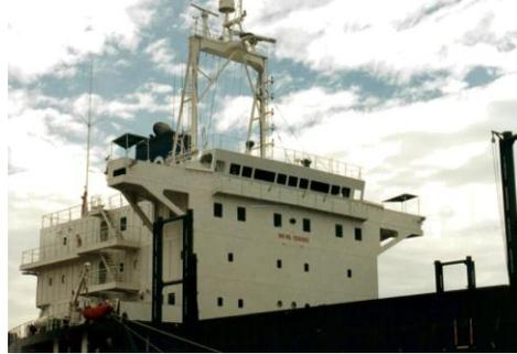
*Alloggi dell'equipaggio (soprastruttura): comprendono camere da letto, mense, servizi sanitari, degenze ospedaliere e locali di svago previsti per l'uso dell'equipaggio.*
