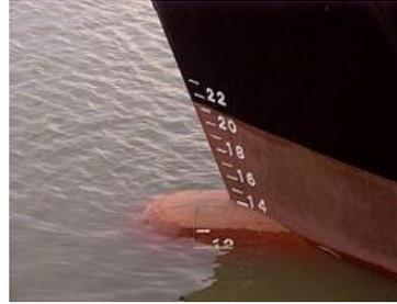
Il pescaggio dello scafo di una nave è la distanza verticale tra la linea di galleggiamento e il fondo dello scafo (chiglia). Il progetto determina la profondità minima d'acqua di una nave o imbarcazione può navigare con sicurezza. La scala realizzata dal cantiere mostra il livello di acqua per ogni pescaggio.
