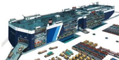
*Navi roll-on/roll-off: navi da carico adibite al trasporto di carichi su ruote come automobili, rimorchi o vagoni ferroviari. Le navi RoRo sono dotate di rampe che consentono il carico su e giù. Le automobili nuove vengono trasportate su grandi RORO chiamati Pure Car Carrier (PCC) o Pure Car Truck Carrier (PCTC).*
