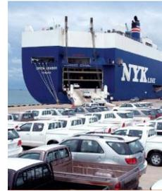
*La Rampa è un tipo di ponte levatoio utilizzata principalmente nella gestione del movimento di veicoli dentro e fuori una RO-RO o traghetto. La nave usa una combinazione di rampe o di poppa, prua o laterale (o una combinazione) per caricare o scaricare auto, furgoni, camion e autobus a terra.*
