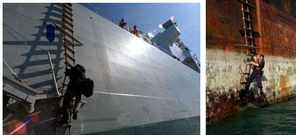
**Scala Piloti (Biscagliana):** forma altamente specializzata di scala di corda, in genere utilizzata per imbarco e sbarco dei piloti. Quando non viene utilizzata, la scaletta viene riposta (in genere arrotolata), piuttosto che lasciata sospesa.
