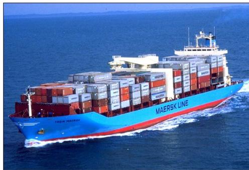
*Navi portacontainer: navi da carico che trasportano il loro intero carico in contenitori dimensionati ai camion, in una tecnica chiamata containerizzazione.*
