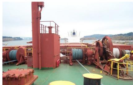
**Ponte:** copertura permanente su un compartimento o uno scafo di una nave. Il ponte principale o superiore è la struttura orizzontale che forma il 'tetto' dello scafo. Le navi hanno spesso più livelli sia all'interno dello scafo che nella sovrastruttura, sopra il ponte principale.
